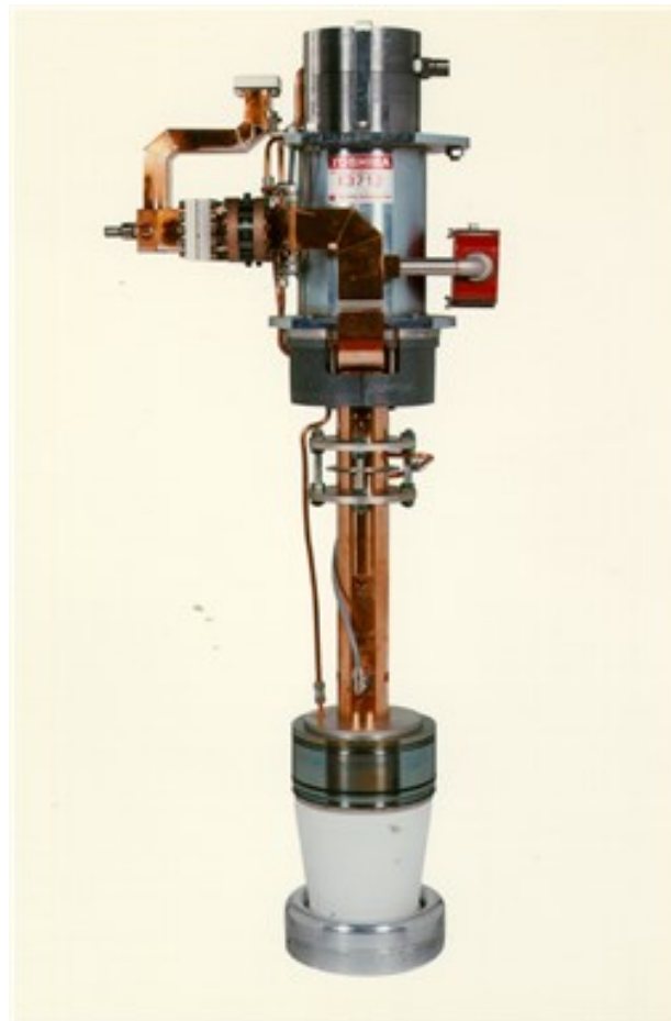
<Figure 2.1.4.33> Photo of a 70MW E37366 klystron.
